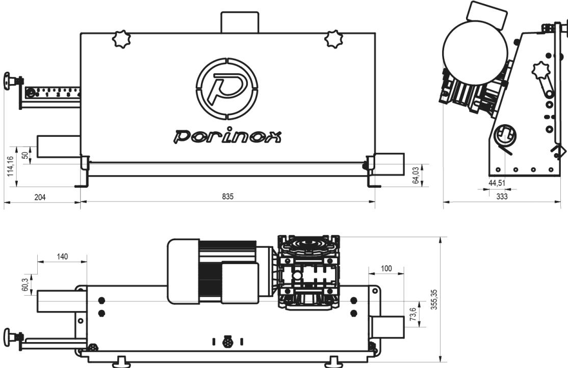
La Unidad de Arrastre de Porinox es un **sistema automático** accionado por un moto-reductor de 1,5kW, que distribuye el pienso mediante el sistema de cadena.
